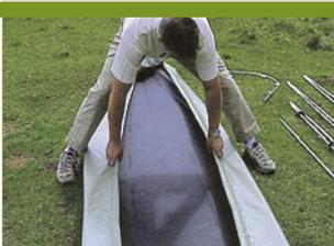
Montieren Sie das Kielspant und die Steven.
