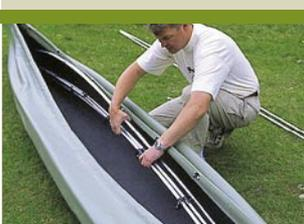
Montieren Sie das längste doppelte Spant auf den obersten Haken der Steven.
