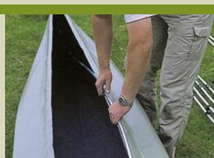
Das zweitlängste doppelte Längsspant auf die gleiche Weise einsetzen.
