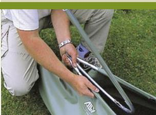
Das gerade Ende des Stevens ragt jetzt aus dem Boot. Das Kielspant wird aufgesteckt. Drücken Sie das Kielspant gegen den Boden ...
