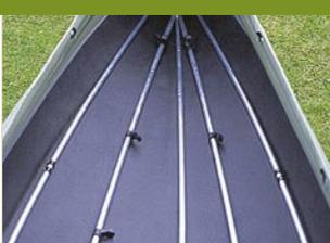
Zu guter Letzt werden die Querspannen eingebracht, die dem Kanadier seine Stabilität verleihen.
